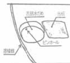
B部分詳細図 タンク本体水だめ (ピンホール1ヶ所)
