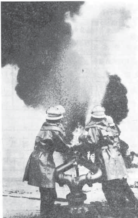
〔写真〕油火災消火実験で泡放射する放水砲
