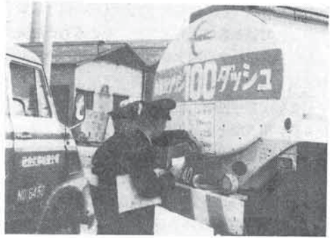
〔写真〕非常閉鎖弁を点検する検査員
