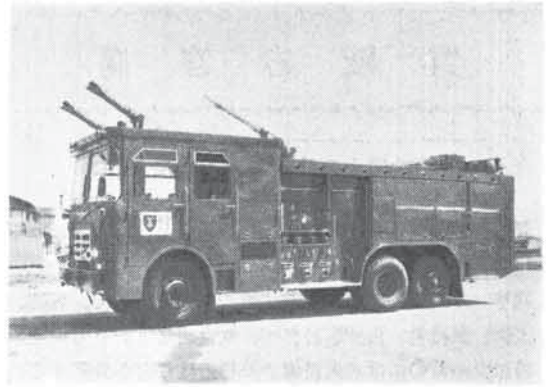
空港消防車にみられるようなキャブオーバータイプで、ケミカルフォームの発生装置を備え、最高毎分5,000ℓの吐出量を有している。
