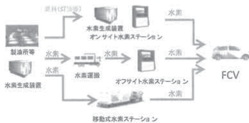
図1 FCVへの水素供給方式
