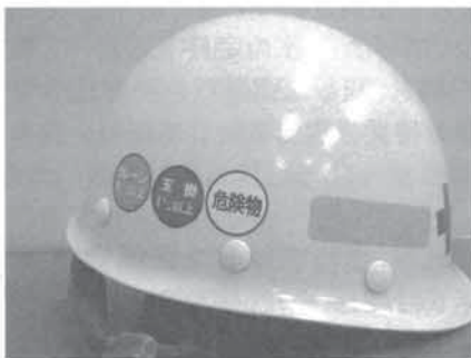
危険物取扱者などの資格はヘルメットに表示
