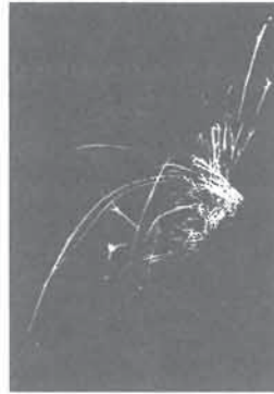
鉄重錘重量15kg 被衝撃板(鉄)角度45度
