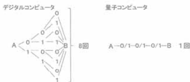
図 デジタルコンピュータと量子コンピュータの計算の違い
