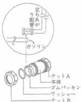
立ちあがり配管部分拡大
